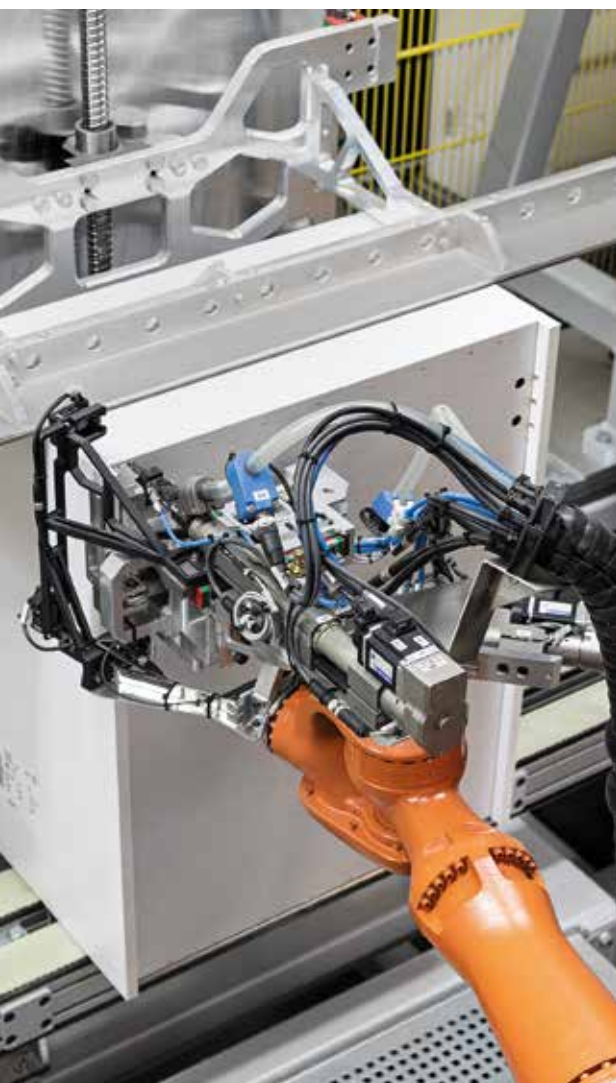
Vollautomatische Anlage zur Montage von Scharnieren
