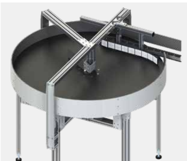
Vereinzelung beim Ausschleusen über diverse Führungen möglich
